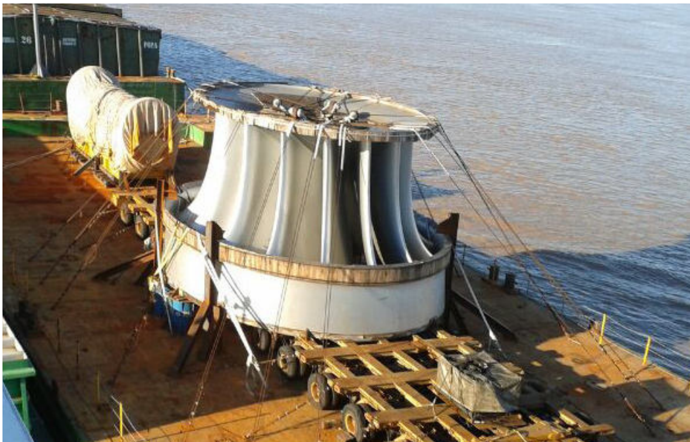
O equipamento tem mais de oito metros de diâmetro e pesa cerca de 290 toneladas
