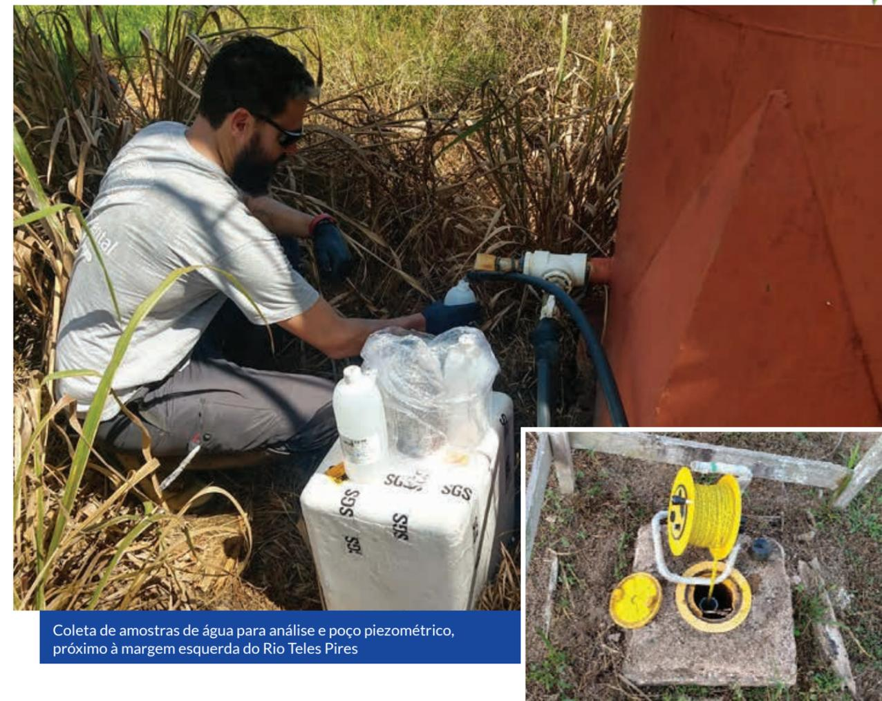
Coleta de amostras de água para análise e poço piezométrico, próximo à margem esquerda do Rio Teles Pires
