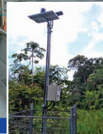
Estação hidrométrica mede nível e vazão dos rios e das chuvas
