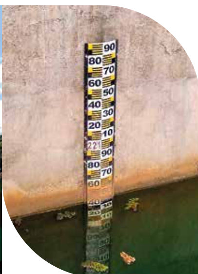
Régua de nível do barramento (esquerda) e uma sessão de régua (direita) medem o nível dos rios
