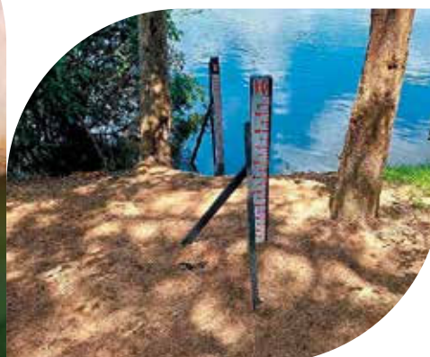
Régua de nível do barramento (esquerda) e uma sessão de régua (direita) medem o nível dos rios
