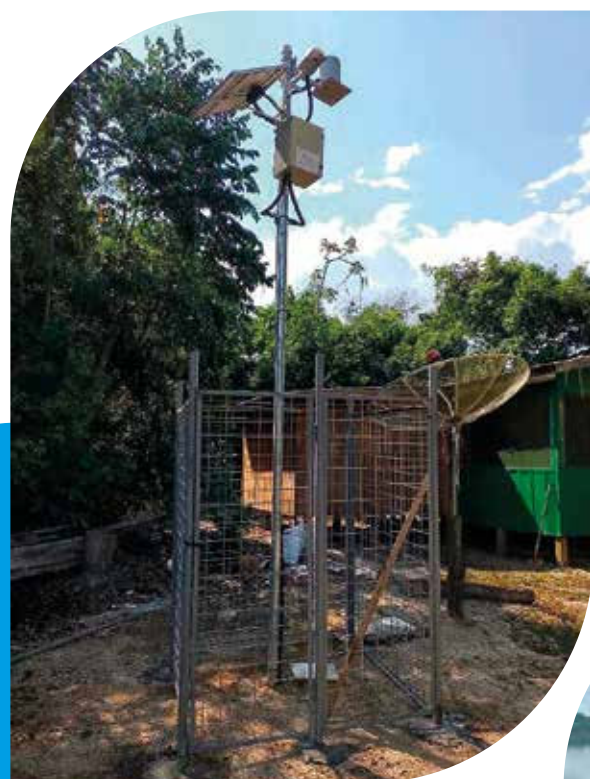
Instalação da estação pluviométrica Montante III
